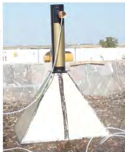
CAPPA STATICA sorgenti areali con un flusso emissivo proprio Isola una parte di superficie e permette di convogliare il flusso nel condotto di uscita
