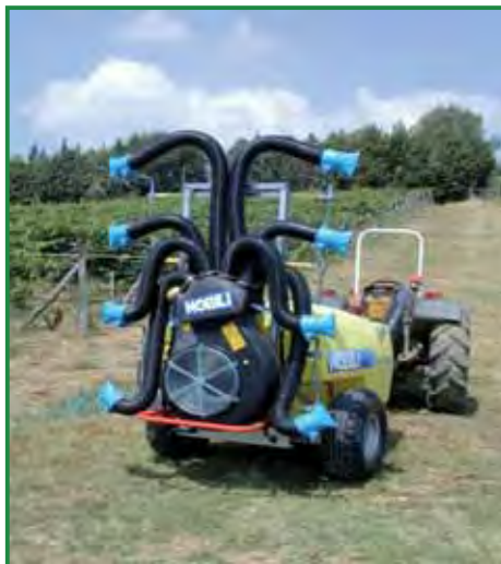
Fig. 6 Irroratrice a getti orientabili (i moduli di irrorazione possono essere regolati indipendentemente e direzionati sulle diverse zone vegetative). Fonte: DIAF
