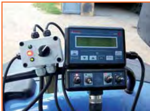
Fig.10 Dispositivo per il monitoraggio della carica elettrostatica durante il trattamento.
