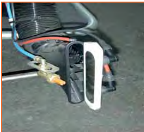
Fig. 9 Elettrodo applicato a una bocchetta di un atomizzatore.
