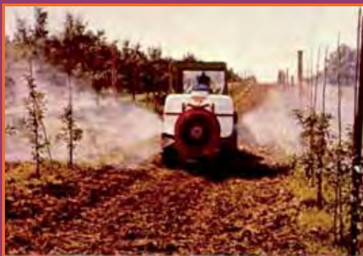
Fig. 4 Atomizzatore classico a polverizzazione meccanica . Fonte: DIAF
