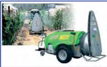
Fig. 7 Configurazione a torretta. Fonte: Tifone
