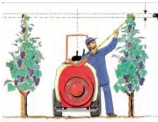
Fig. 16 Regolazione dei deflettori in base alla conformazione del bersaglio. Fonte: Syngenta
