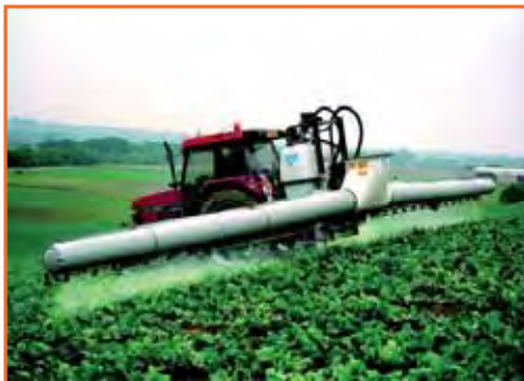
Fig. 3 Barra aeroassistita . Fonte: DIAF
