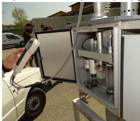
Installazione campionatore ARPAT per verifica in parallelo alla centralina Italferr.
