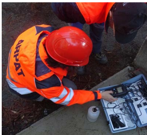
Misura parametri su acqua prelevata da piezometro di monitoraggio.
