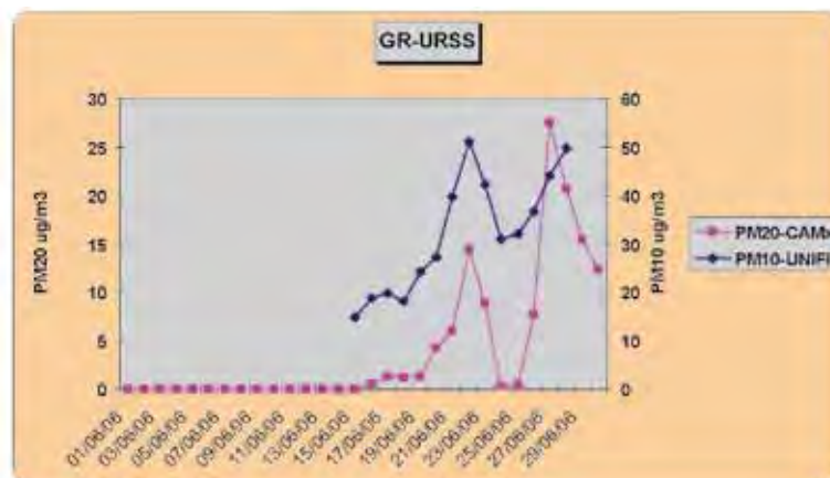
Fig. 28 - Grafico della concentrazione media giornaliera di polvere sahariana simulata da CAMx (PM20-dust) e del PM10 totale misurato nel sito recettore di Grosseto.
