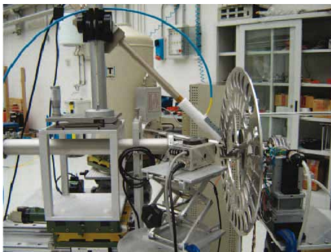
Figura 1.5 – Foto dell'apparato sperimentale utilizzato per le misure PIXE (presso il laboratorio LABEC dell'Istituto Nazionale di Fisica Nucleare – Sezione di Firenze).
