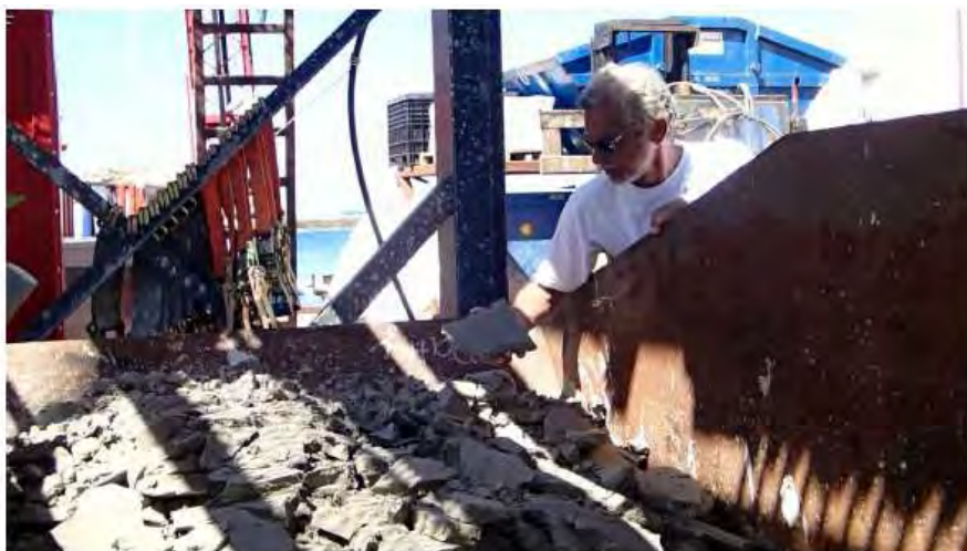
Il fango compattato raccolto sotto il filtro-pressa
