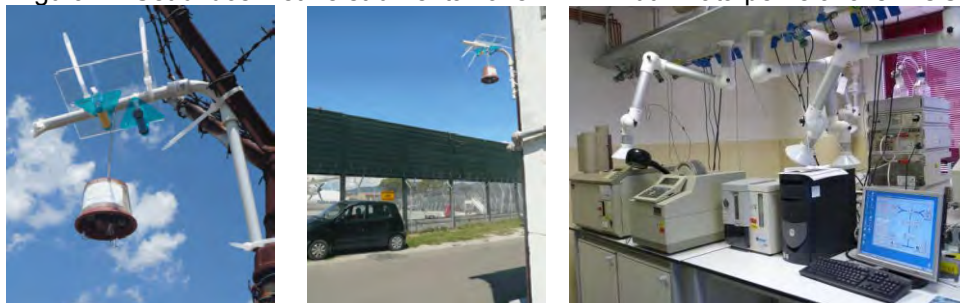
Figura 1 - Set di dosimetri e strumentazione ARPAT utilizzata per le analisi VOC.
