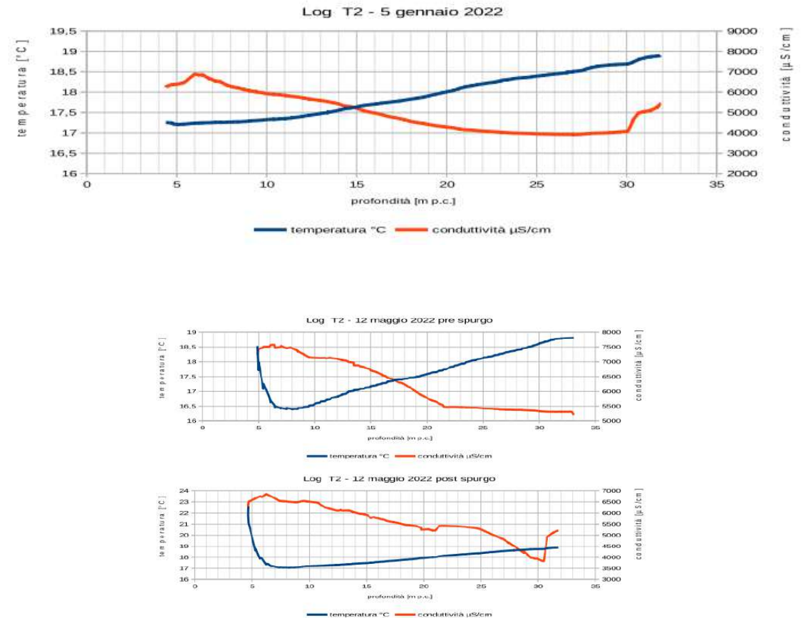
Figura 5: profili di temperatura e conduttività nel pozzo T2
