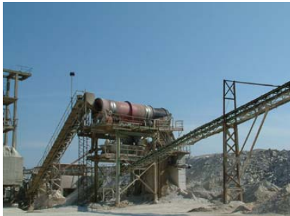
Fig 12: macchinario per frantumare la ghiaia posto nelle vicinanze del fiume (Foto S. Sgroi).
