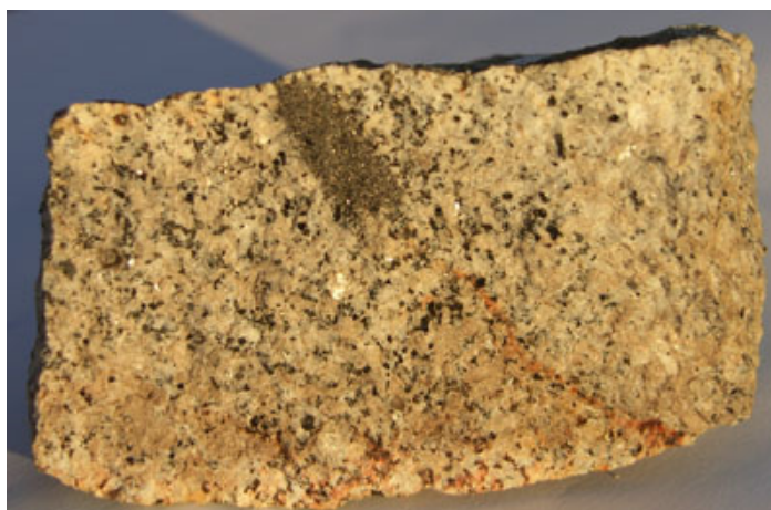
Figura 6 - Frammento di granodiorite del Monte Capanne con i cristalli scuri di mica in evidenza
