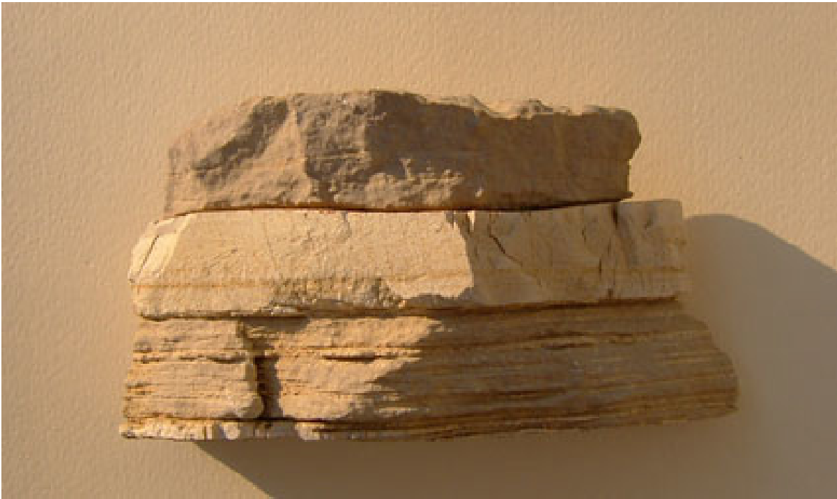
Figura 4 – Roccia sedimentaria: differenti litotipi in uno strato di roccia calcarea (Giurassico del M. Elefante, gruppo del Terminillo, Rieti)
