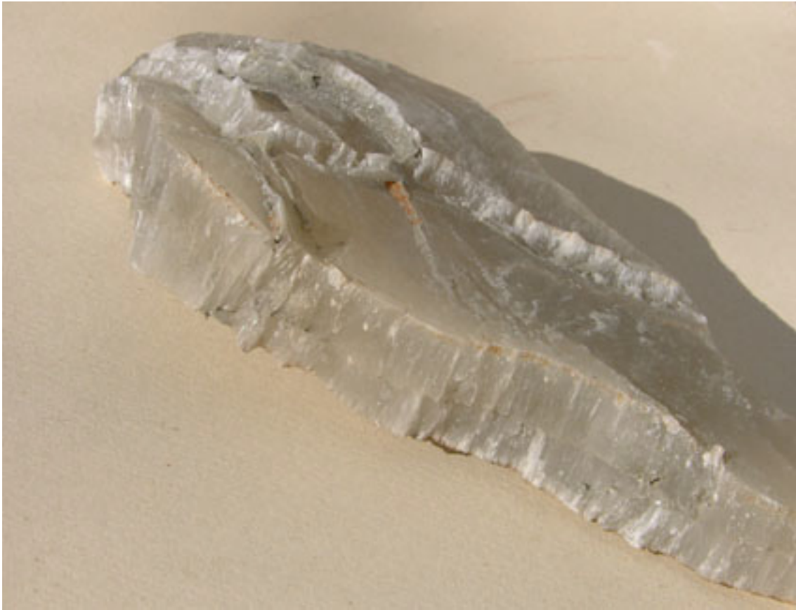
Figura 6 – Il gesso, un minerale molto solubile (formazione gessosa del Miocene dei dintorni di Volterra)
