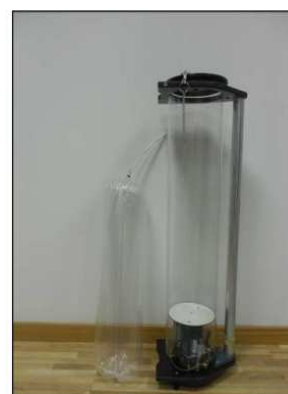
Immagine 10 Schema di prelievo con pompa a depressione e campionatore passivo con sacco in Nalophan
