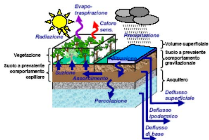
Figura 15: Schema concettuale del Modello MOBIDIC
