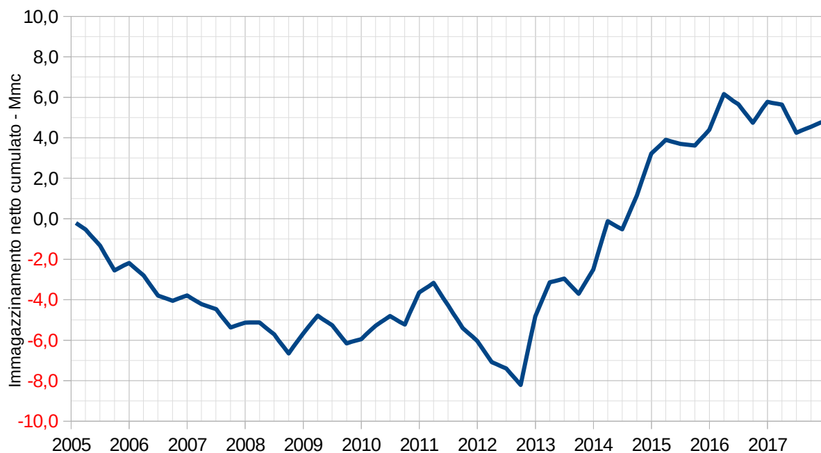
Figure 65: Idrogramma dell'immagazzinamento netto cumulato per il corpo idrico "A" (dx Fiume Cecina)
