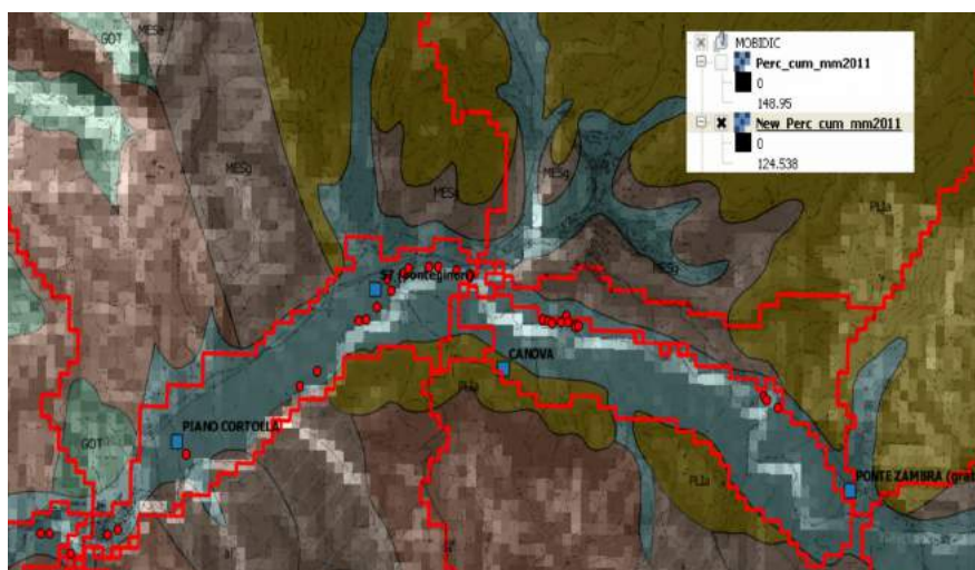
Figura 9: Altezze di percolazione dal modello MOBIDIC
