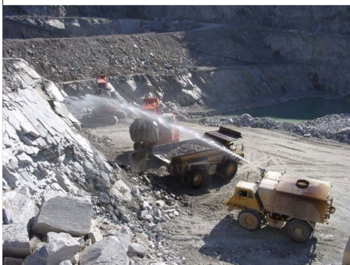
Bagnatura del fronte estrattivo di una cava
