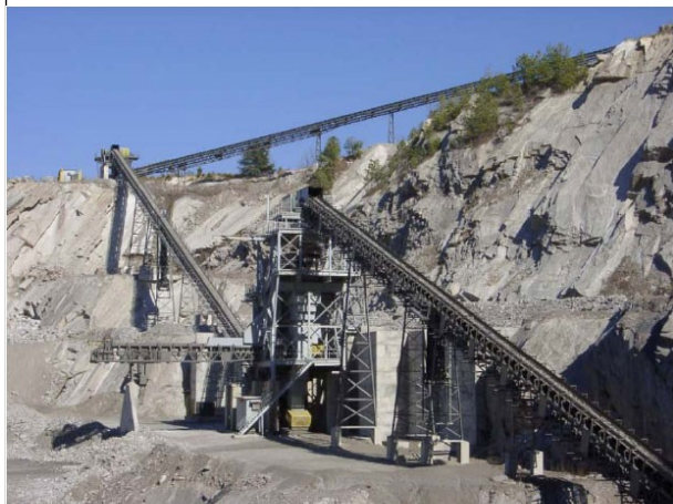
Sistema di movimentazione e frantumazione secondaria di materiale inerte
