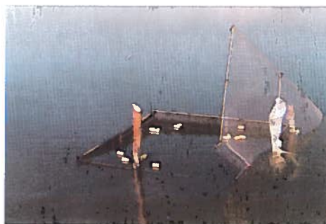
Fig. 9 Gabbia metallica utilizzata per la verifica della possibilità di crescita delle macrofite nel lago
