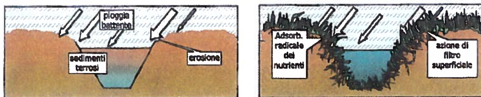
Fig. 10 Sezione delle scoline, prima e dopo l'inerbimento.
