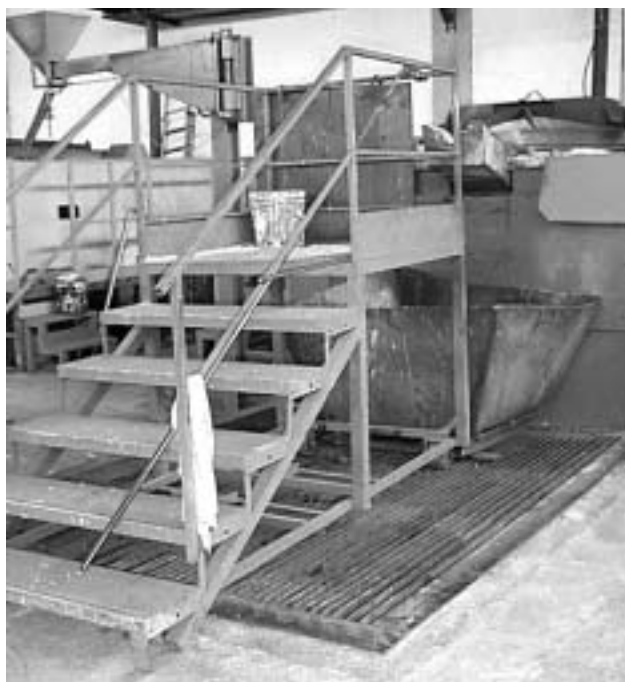
Fig. 3.9.10 Attrezzatura per la scorificazione al forno elettrico a induzione
