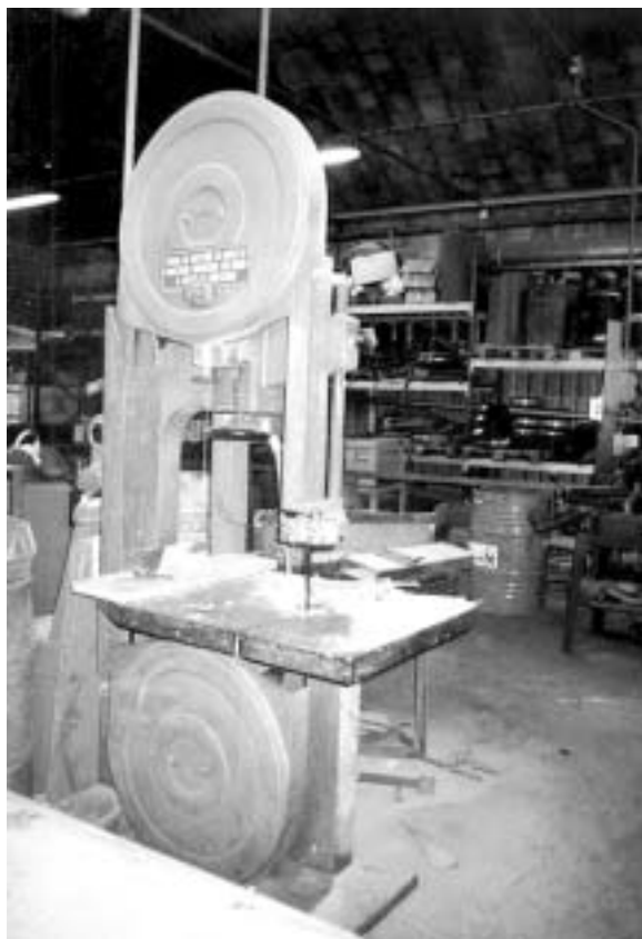
Fig. 3.1.2 Sega a nastro per la riparazione dei modelli
