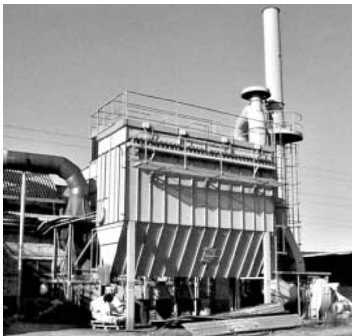
Fig. 3.9.25 Impianto abbattimento a secco (maniche) per le emissioni provenienti dai forni fusori di una fonderia
