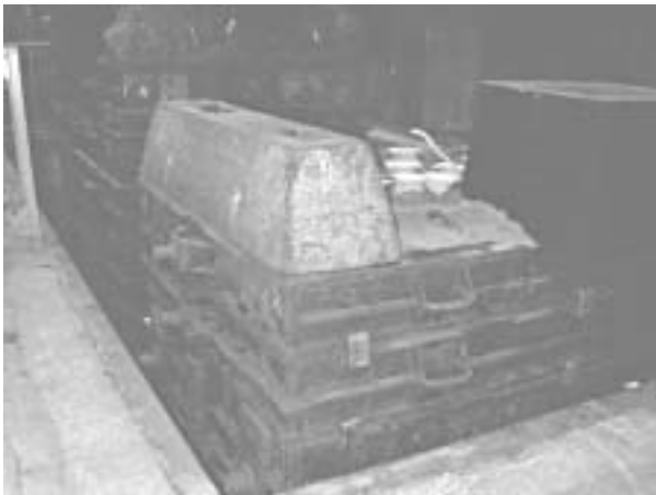
Fig. 3.10.10 Staffa grande chiusa con grappe e con sopra il peso per controbilanciare la forza metallostatica
