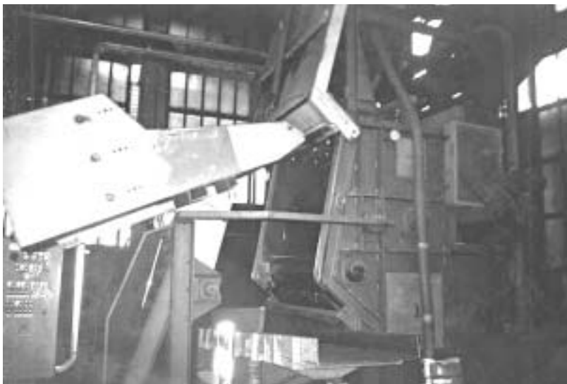
Fig. 3.13.1 Sabbiatrice a tappeto durante il caricamento dei getti. Si noti il caricatore automatico a sollevamento pneumatico (a sinistra) ed il coperchio scorrevole aperto (in alto)
