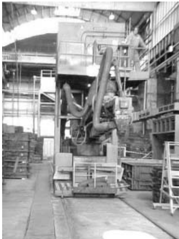
Fig. 3.4.2 A/B Carro su rotaia (chiamato in gergo cammello ) con braccio mobile per riempimento delle staffe grandi con terra di fonderia nel reparto di formatura manuale (Fig. A: in posizione di carico dalla tramoggia; Fig. B: in posizione di scarico nelle staffe, con operatore a bordo)
