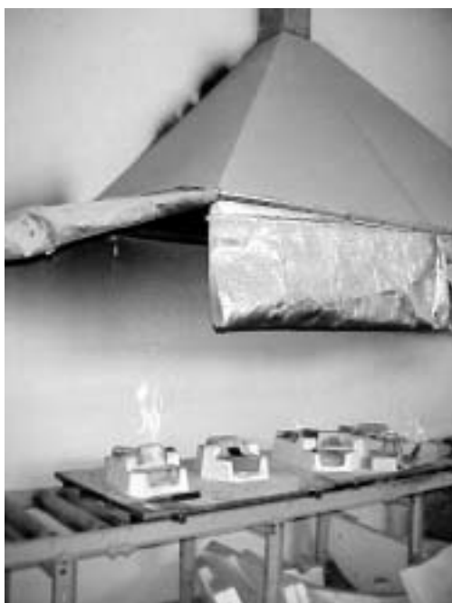
Fig. 3.6.12 Flambatura anime in ceramica sotto aspirazione
