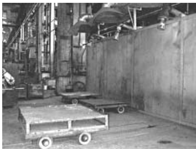
Fig. 3.11.5 Carrelli per la movimentazione di siviere da porre sotto l'impianto di trattamento termico
