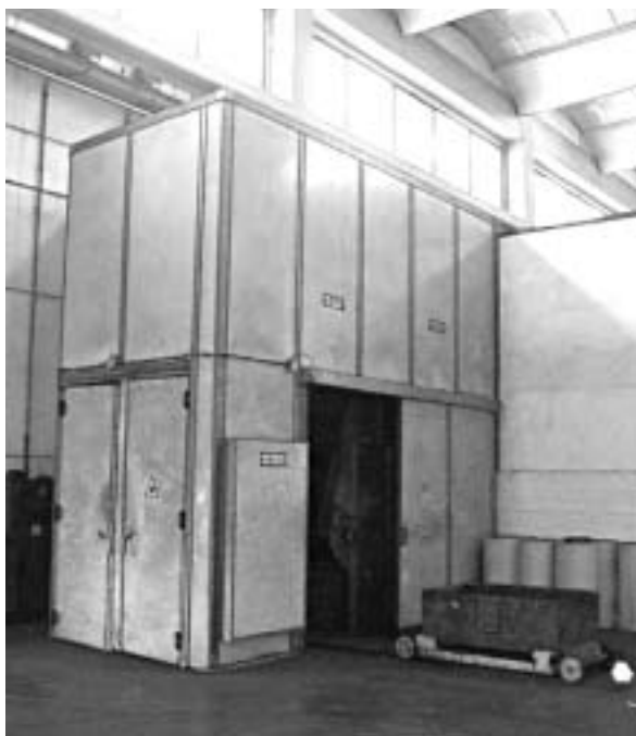
Fig. 3.13.4 A/B Cabina integrale della granigliatrice a tappeto. A: particolare del carrellino su rotaia per l'estrazione dei getti trattati dalla granigliatrice a tappeto cabinata. B: vista d'insieme della granigliatrice a tappeto cabinata
