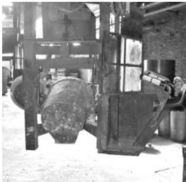
Fig. 3.10.16 Colata dalla siviera nelle forme tramite il carro di colata, alla linea di staffe preparate con sistema di formatura automatica
