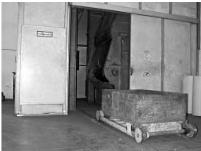
Fig. 3.13.4 A/B Cabina integrale della granigliatrice a tappeto. A: particolare del carrellino su rotaia per l'estrazione dei getti trattati dalla granigliatrice a tappeto cabinata. B: vista d'insieme della granigliatrice a tappeto cabinata
