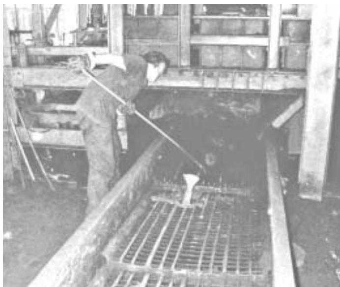
Fig. 3.12.4 Prelevamento dei pezzi dalla griglia vibrante all'uscita della distaffatura: A) tramite un'asta di acciaio con la punta ricurva; B) tramite pinza pneumatica sostenuta da un paranco
