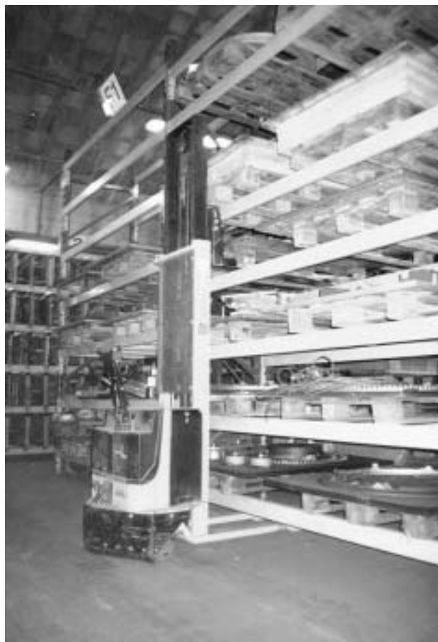
Fig. 3.1.4 A/B Scaffalature per stoccaggio modelli e movimentazione con transpalletts. A: con carrello; B: con carroponte
