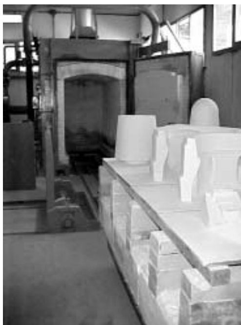
Fig. 3.6.13 Introduzione in forno delle anime in ceramica
