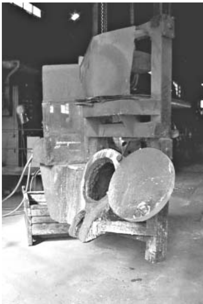
Fig. 3.10.16 Colata dalla siviera nelle forme tramite il carro di colata, alla linea di staffe preparate con sistema di formatura automatica
