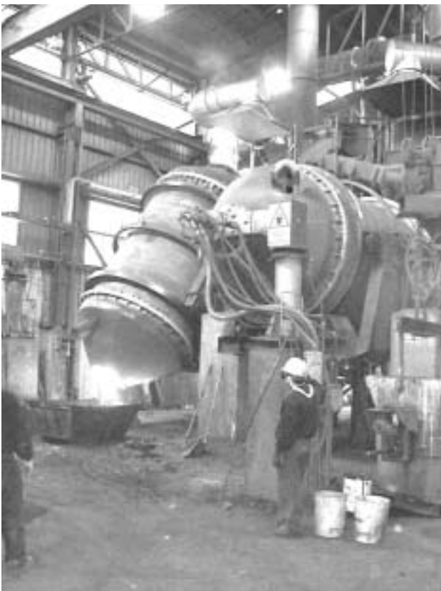
Fig. 3.9.14 Due forni rotativi di cui uno in fase di scorifica entro un cassone metallico
