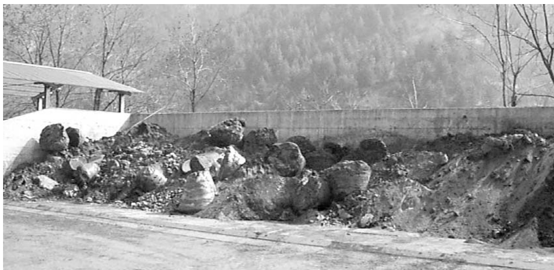
Fig. 4.1.1 Stoccaggio temporaneo esterno delle scorie di fusione con forni a cubilotto
