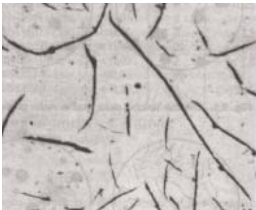
Fig. 3.9.1 Ghisa grigia a grafite lamellare (ingrandimento: 300 x)
