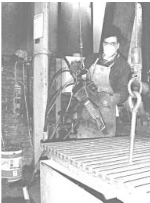
Fig. 3.12.8 Addetto alla smaterozzatura con smaterozzatrice a cuneo
