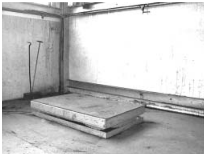
Fig. 3.4.4 Piattaforma per sollevare piccole staffe durante la formatura manuale
