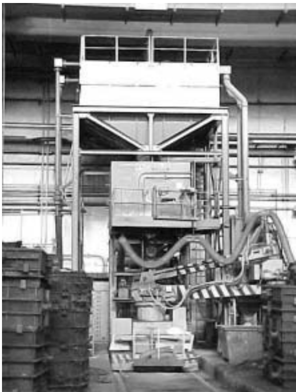
Fig. 3.4.2 A/B Carro su rotaia (chiamato in gergo cammello ) con braccio mobile per riempimento delle staffe grandi con terra di fonderia nel reparto di formatura manuale (Fig. A: in posizione di carico dalla tramoggia; Fig. B: in posizione di scarico nelle staffe, con operatore a bordo)
