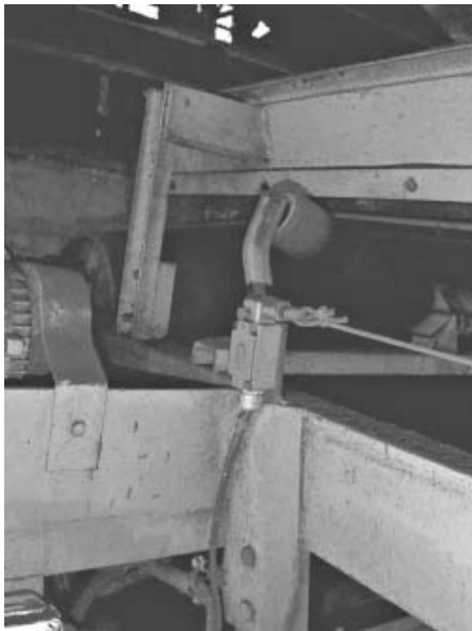
Fig. 3.2.6 Filo di sicurezza lungo il nastro trasportatore collegato al dispositivo di arresto di emergenza
