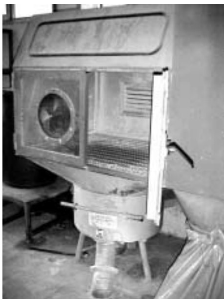
Fig. 3.6.10 Sistema chiuso per l'apertura manuale dei sacchi di materiale in polvere dotato di aspirazione e trasporto pneumatico. Si notino le guarnizioni in gomma sugli sportelli per l'introduzione delle braccia per aprire il sacco, la griglia di aspirazione sul fondo, il sacco di plastica per la raccolta sacchi polverosi vuoti, il tubo che entra sotto il pavimento per il trasporto pneumatico del prodotto in polvere verso il mescolatore
