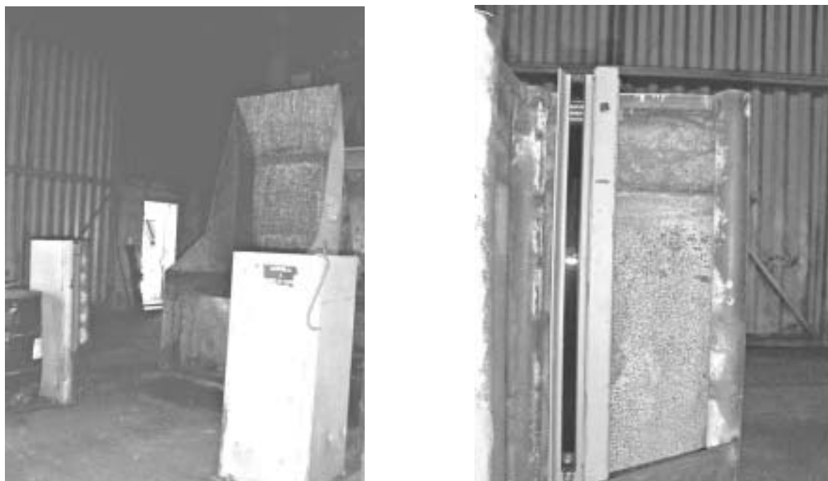
Fig. 3.13.3 A/B: sistema di protezione con fotocellule al caricatore automatico della sabbiatrice a tappeto. A: vista d'insieme; B: particolare della barra di fotocellule
