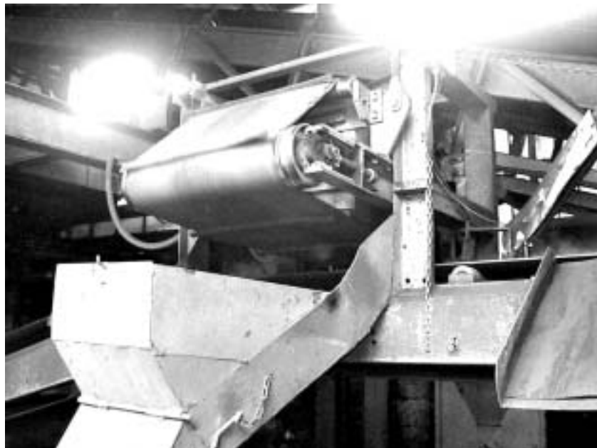
Fig. 3.2.4 Deferrizzatore ortogonale al nastro trasportatore; in primo piano lo scivolo di raccolta del metallo
