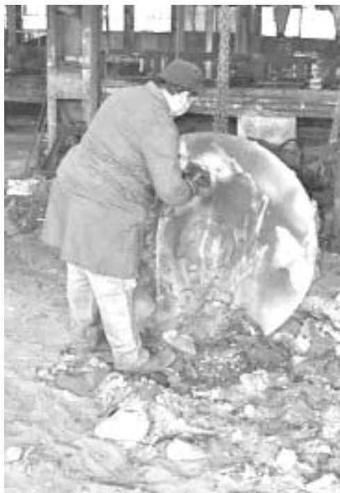
Fig. 3.12.5 Disterratura con attrezzi manuali di un getto di grandi dimensioni realizzato tramite colata della lega metallica in una forma realizzata con il processo di formatura manuale in anidride carbonica
