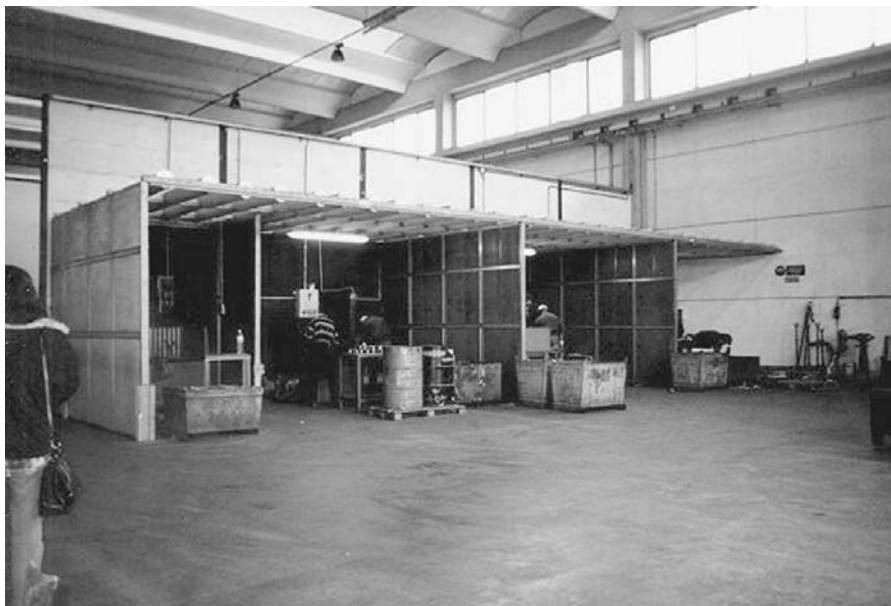
Fig. 3.14.4 Postazioni di lavoro cabinate semichiusate per sbavatura manuale in locale separato da altre lavorazioni
