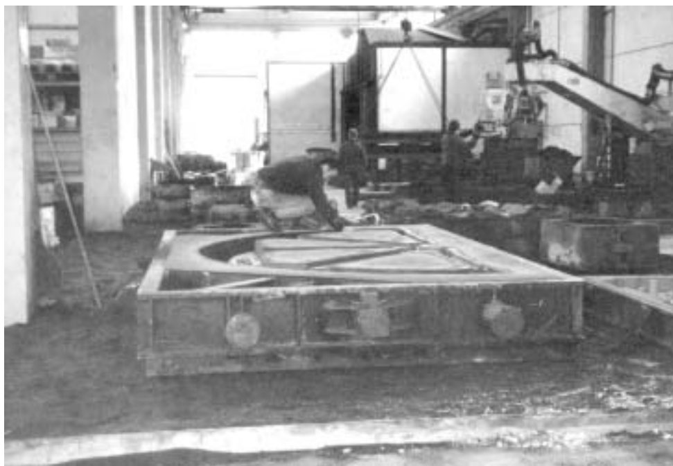
Fig. 3.8.1 Operazioni di ramolaggio (linea di formatura manuale)
