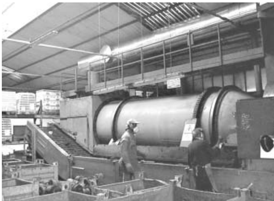
Fig. 3.12.3 Prelevamento dei getti prodotti distaffati dalla linea automatica e usciti dal disterratore a tamburo rotante (posto sotto aspirazione). Gli addetti rompono le materozze con la mazza e recuperano getti e materozze dal trasportatore corrugato che è posto a una altezza tale da permettere agli addetti di mantenere la posizione eretta
