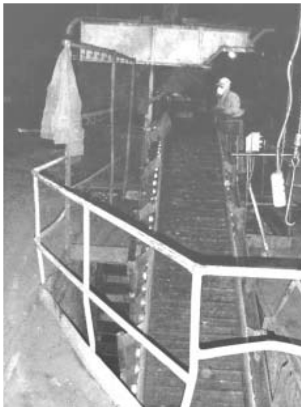
Fig. 3.12.2 Uscita dei getti distaffati dalla linea automatica
