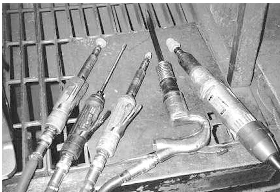
Fig. 3.14.3 Vari utensili per la sbavatura delle cavità dei getti
