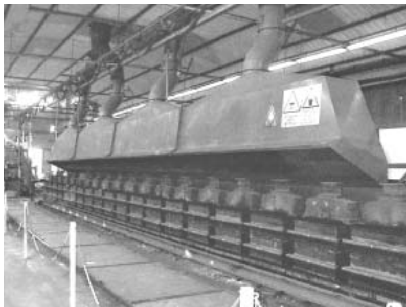
Fig. 3.10.19 Impianto di aspirazione su linea di colata nelle forme realizzate con un impianto formatura automatica a verde
