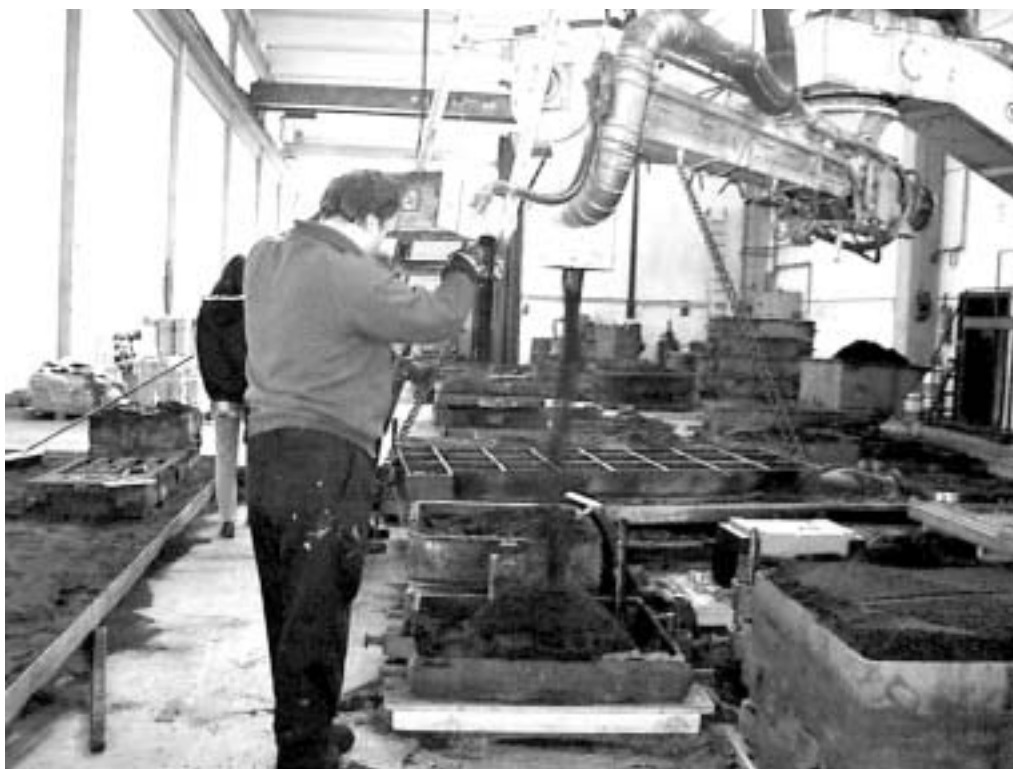
Fig. 3.4.1 Riempimento staffe con terra di fonderia nel reparto di formatura manuale con impianto fisso. Si noti il tubo per l'aspirazione localizzata sulla bocca di uscita della terra dal mescolatore a coclea
