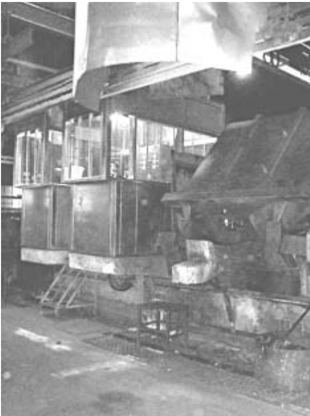
Fig. 3.9.18 Forno elettrico con cappa di aspirazione localizzata e postazione di comando e controllo cabinata
