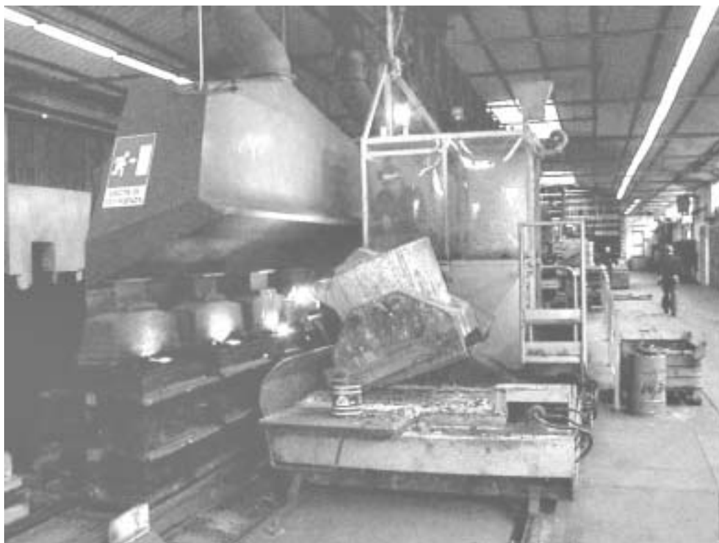
Fig. 3.10.16 Colata dalla siviera nelle forme tramite il carro di colata, alla linea di staffe preparate con sistema di formatura automatica
