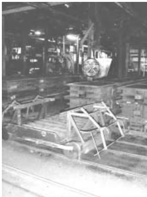
Fig. 3.3.2 Carrellino su rotaia per la movimentazione automatica delle staffe
