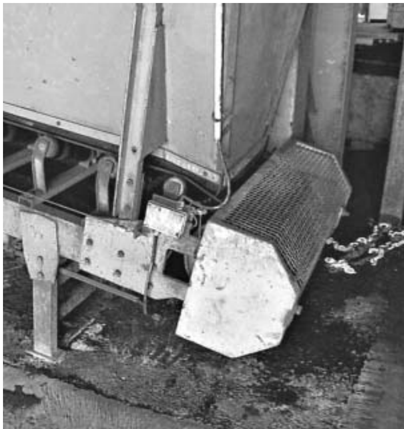
Fig. 3.2.7 Esempio di protezione grigliata sulla testata del nastro trasportatore che parte da sotto la molazzatrice
