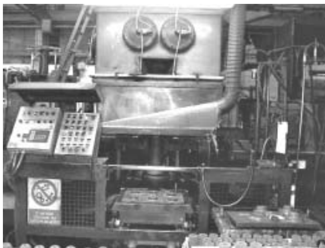
Fig. 3.3.1 Macchina formatrice a pressione con aspirazione localizzata in impianto automatico; si noti il modello all'interno della macchina
