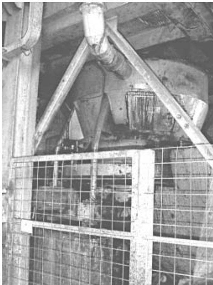
Fig. 3.2.5 Recinzione di protezione alla molazzatrice
