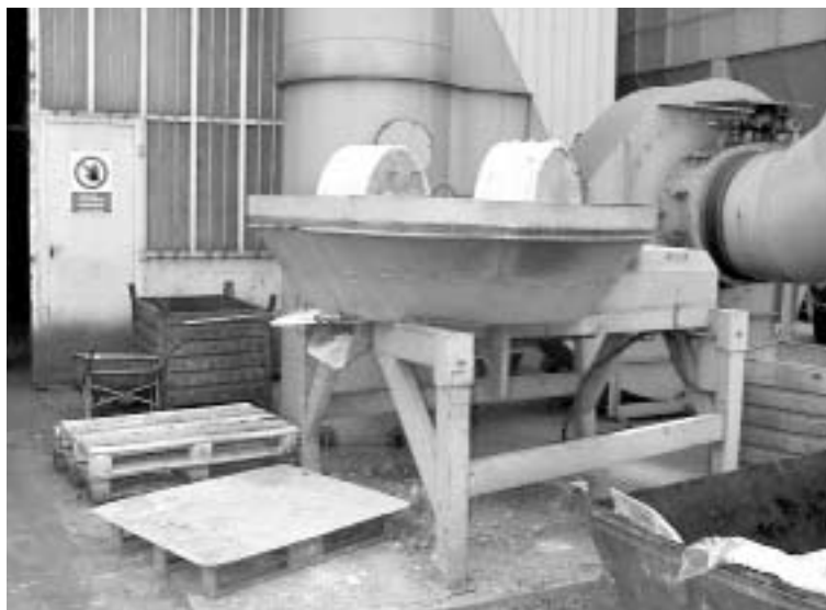
Fig. 3.11.2 Molazza per la preparazione della terra refrattaria (macchina con protezioni rimosse)
