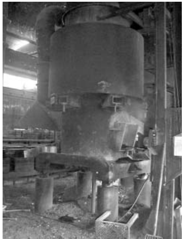
Fig. 3.9.15 Particolare del retro di un forno a cubilotto in pausa
