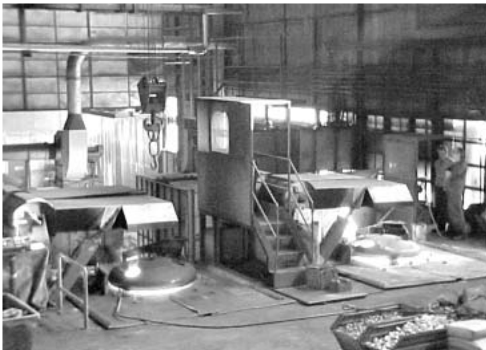
Fig. 3.9.9 Forni elettrici a induzione visti da sopra dotati di cappe mobili di aspirazione e postazione di controllo schermata (i quadri di comando di tutto l'impianto si trovano in una cabina insonorizzata a lato della piattaforma). Il forno di destra è pieno di lega metallica fusa pronta per essere spillata (Fig. 3.9.23 A/B/C), mentre il forno di sinistra è al momento inattivo e si nota che in esso è inserita la fiaccola accesa per mantenere caldo il refrattario (si vede bene la fiaccola appoggiata sotto il coperchio e il tubo flessibile, disteso lungo la piattaforma, di collegamento all'impianto del gas metano)
