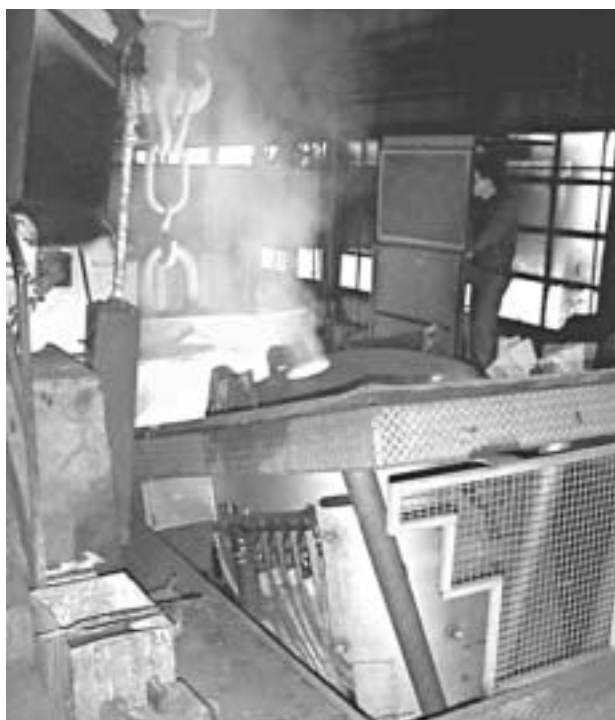
Fig. 3.9.23 (A, B, C) Forni fusori ad induzione in fase di sollevamento per la spillata del metallo fuso, visti dalla piattaforma sovrastante i forni stessi. Si notino: la protezione a griglia mobile contro il rischio di caduta dalla piattaforma nel vano del forno; le postazioni schermate per l'operatore che manovra il movimento dei forni; il cassone di raccolta delle scorie appoggiato sulla piattaforma
