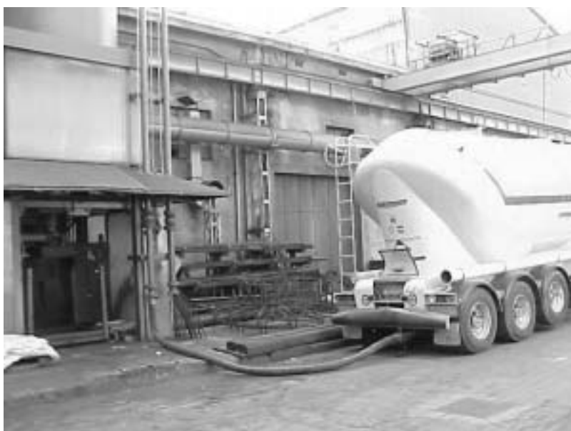
Fig. 3.2.12 A/B Camion autocisterna che carica i silos di sabbia silicea in modo pneumatico senza diffusione di polveri
