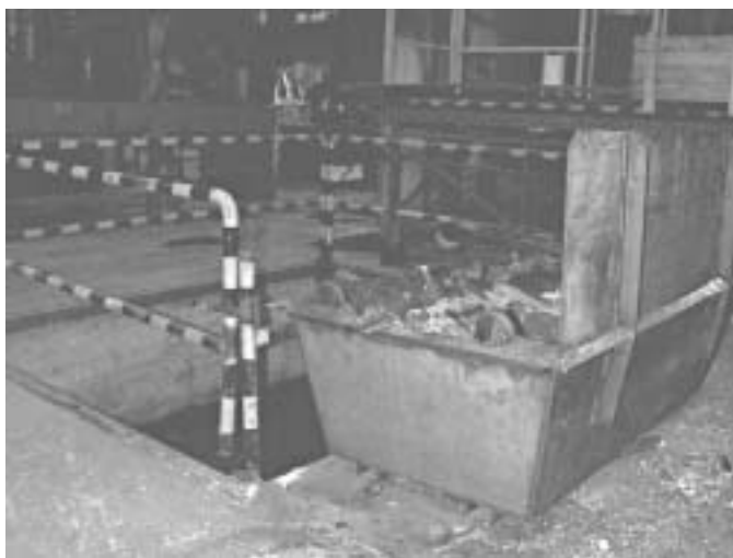
Fig. 3.10.5 Postazione di scorificazione per siviere di grandi dimensioni, con fossa, schermo e parapetti
