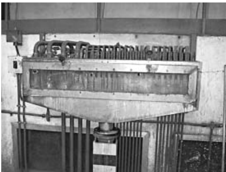
Fig. 3.9.21 Sistema di controllo visivo del circuito idrico di raffreddamento di un forno fusorio a induzione
