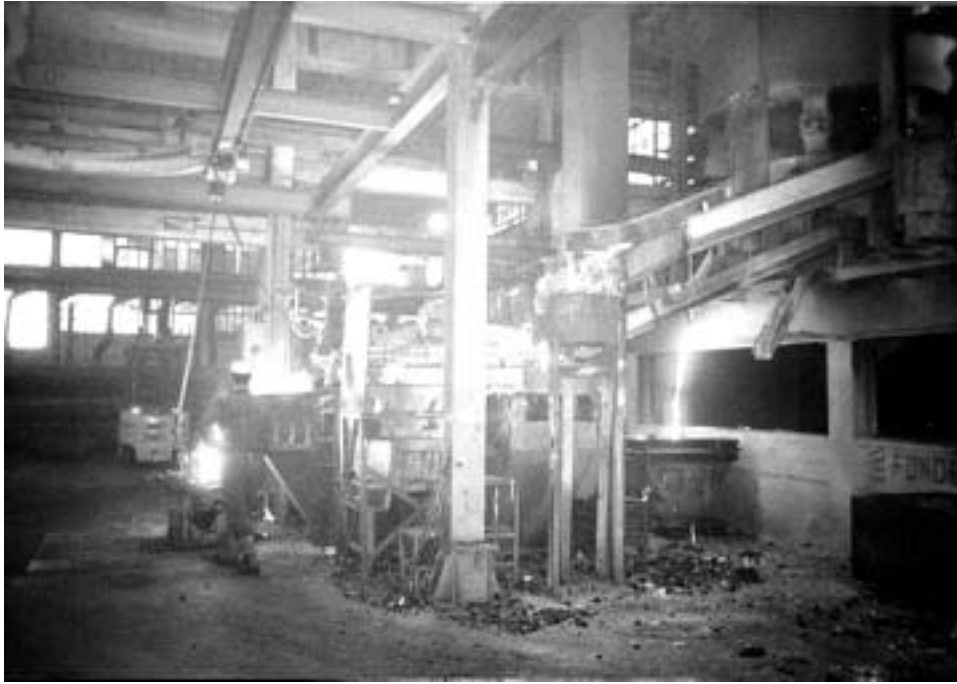
Fig. 3.9.13 Reparto fusione con forno a cubilotto
