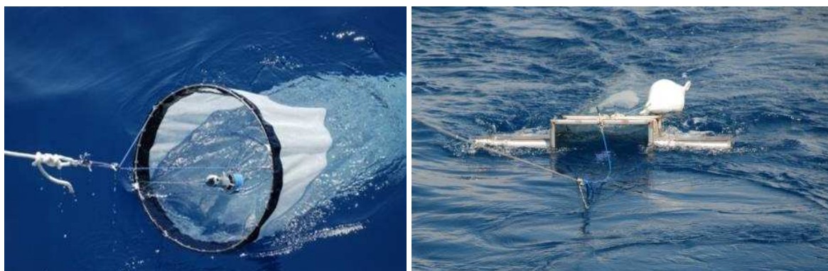
Figura 6.1 – Retino WP2 (a sinistra) e retino "manta" (a destra) utilizzati per i prelievi superficiali delle microplastiche
