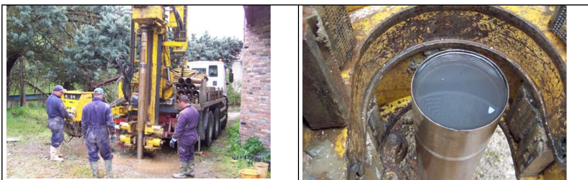
Figura 72. – Sonda a rotazione e prova Lefranc in corso.
