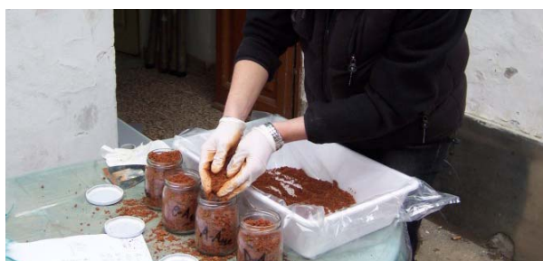
Figura 17. – Quartatura di campioni di sottosuolo.
